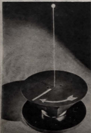
Zdjęcia (jedno u góry i dwa poniżej) ilustrują zasady działania żyroskopu wirowego. Pręt stalowy wykonuje ruch wahadłowy przy każdym wstrząśnięciu. Obrót płyty nie zmienia płaszczyzny wahadłowego ruchu prętu
