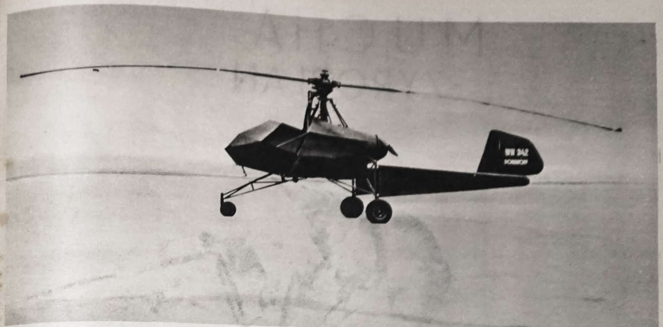
Helikopter raketowy z dodatkowym motorem pomocniczym został zbudowany w Austrii dla Niemców. Obecnie przeprowadzane są z nim próby w Stanach Zjednoczonych. Maszyną wykazuje wiele zalet, a eksperci lotniczy Stanów Zjednoczonych wyrażają opinię, że helikoptery o napędzie raketowym zrewolucjonizują w niedalekiej przyszłości ten dział żeglugi powietrznej
