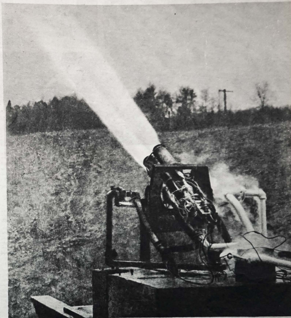
Silnik wyrzuca snop płomieni z czterech cylindrów. Przewód jest chłodzony płynnym tlenem o temperaturze - 360 stopni Fahrenhita
