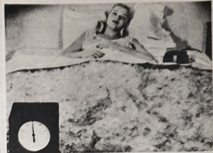
Pokryty lodem koc zachowuje tę samą temperaturę, ale zużywa o wiele więcej prądu
