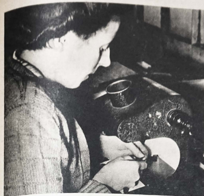
Osadzanie drogocennych kamieni w instrumentach precyzyjnych
