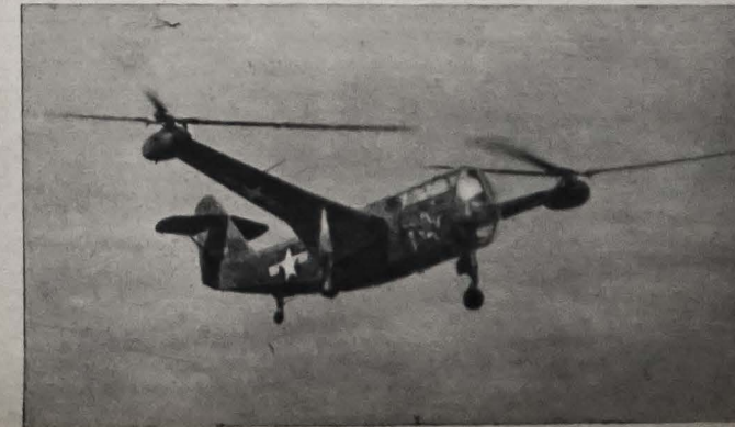
Dwurotorny helikopter Platt-Le Page X—R1, używany w armii amerykańskiej. Ciężar 2.200 kg, silnik — 450 KM
