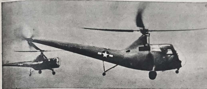
Helikopter Vought — Sikorski X—R5, rozwijający szybkość 160 km na godzinę
