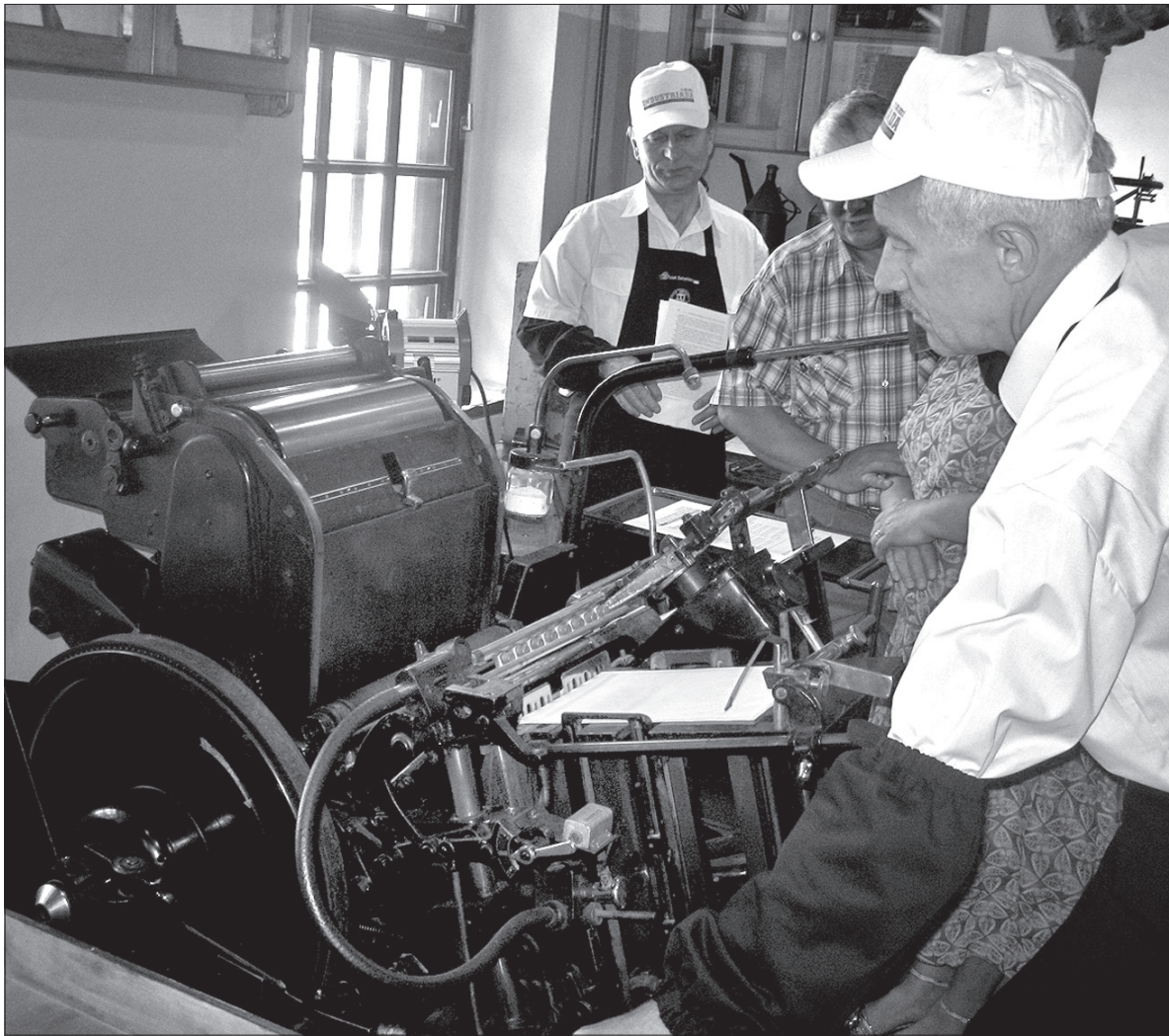
– System ssawek zabierał papier, a tygiel dosuwał go do formy – objaśnia Stanisław Pilch, były maszynista typograficzny.
