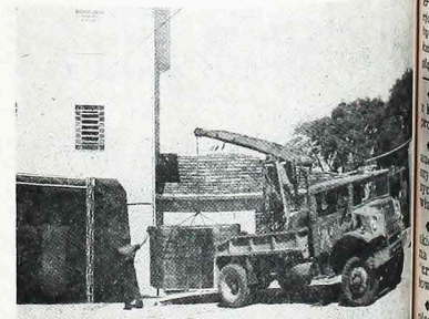
Devido ao grande peso dos caixotes, foi necessário recorrer ao caminhão-guinchô para o descarregamento.
