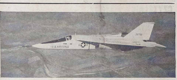
Amerykański odrzutowiec myśliwski "F-111" posiada skrzydła ruchome zwożące się w locie pełnym; przy starcie zaś i lądowaniu rozkładają się stosownie do lotu, którego maksymalna szybkość dochodzi do 2,5 raza większej aniżeli szybkość glosu.
