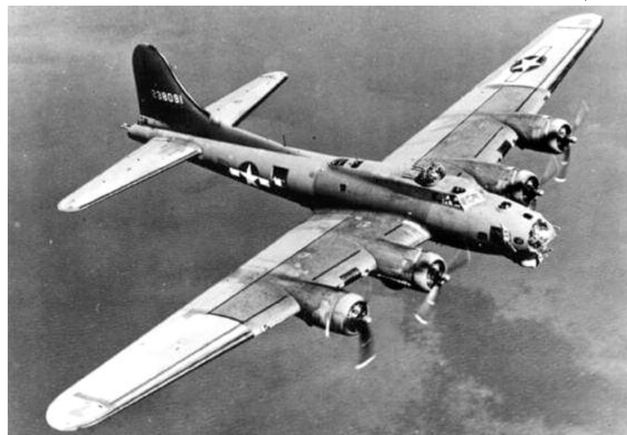
Bombowiec B-17 produkcji Boeinga miał długość ponad 22 metrów i rozpiętość skrzydeł przekraczającą 21 metrów – nie bez przyczyny nazywany był „Latającą Fortecą”
