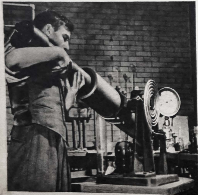
Aparat wysokiego ciśnienia, w którym zachodzi pierwsza faza procesu inkarbonizacji
