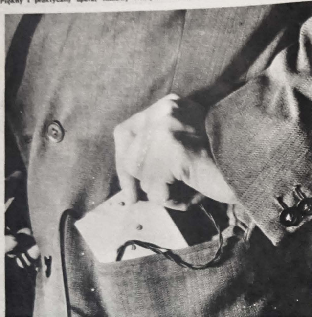
Kieszonkowy aparat radiowy nadawczo-odbiorczy; słuchawki wkłada się do uszu, mikrofon nosi się pod kłapą marynarki
