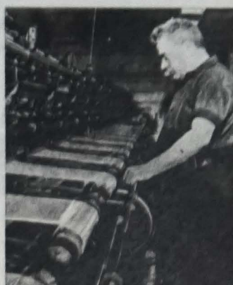
Maszyna trykotarska w ruchu. Robi ona 12 par pończoch równocześnie
