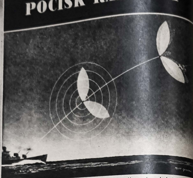
Samolot w zasięgu fal pocisku radiowego powoduje jego wybuch. Na rysunku — białe koła oznaczają wibracje fal, wycinki koła — zasięg pola rażenia
