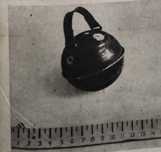
Grenat kulisty, średnicy 15 cm, ze spłonionym zapalnikiem. Rzucany w odkrytym lub spadającym terenie, toczy się daleko, nim następuje eksplozja
