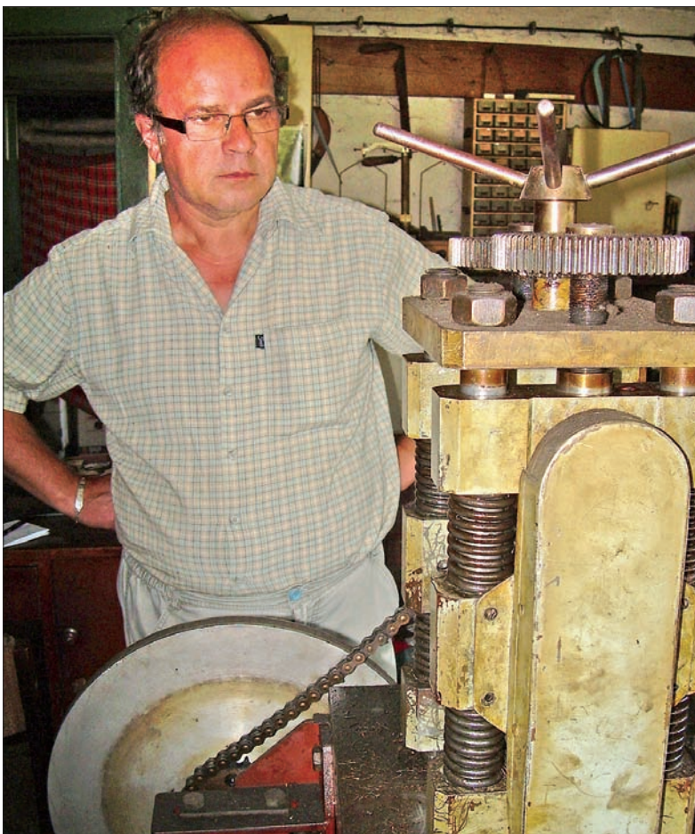
Walcarka do drutu i blachy. Resztę prac pan Kazimierz wykonuje ręcznie.
