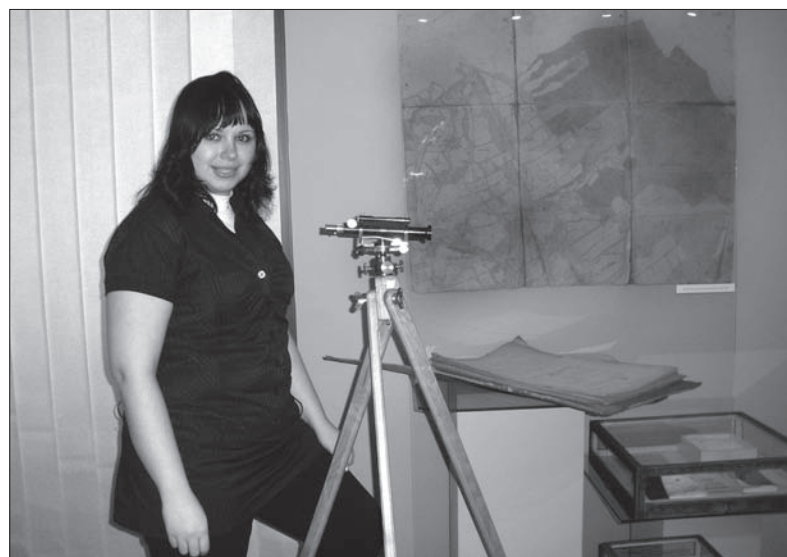
Urządzenie do pomiarów niwelacyjnych (mierzenie różnic wysokości) z przełomu XIX i XX wieku.
