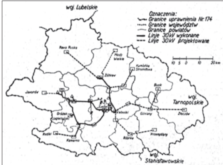
PLAN SIECI 30 KV ZEOL WEDŁUG STANU NA DZIEŃ 1 STYCZNIA 1937 R. (ŹRÓDŁO: „PRZEGLĄD ELEKTROTECHNICZNY” 1937, NR 5)
