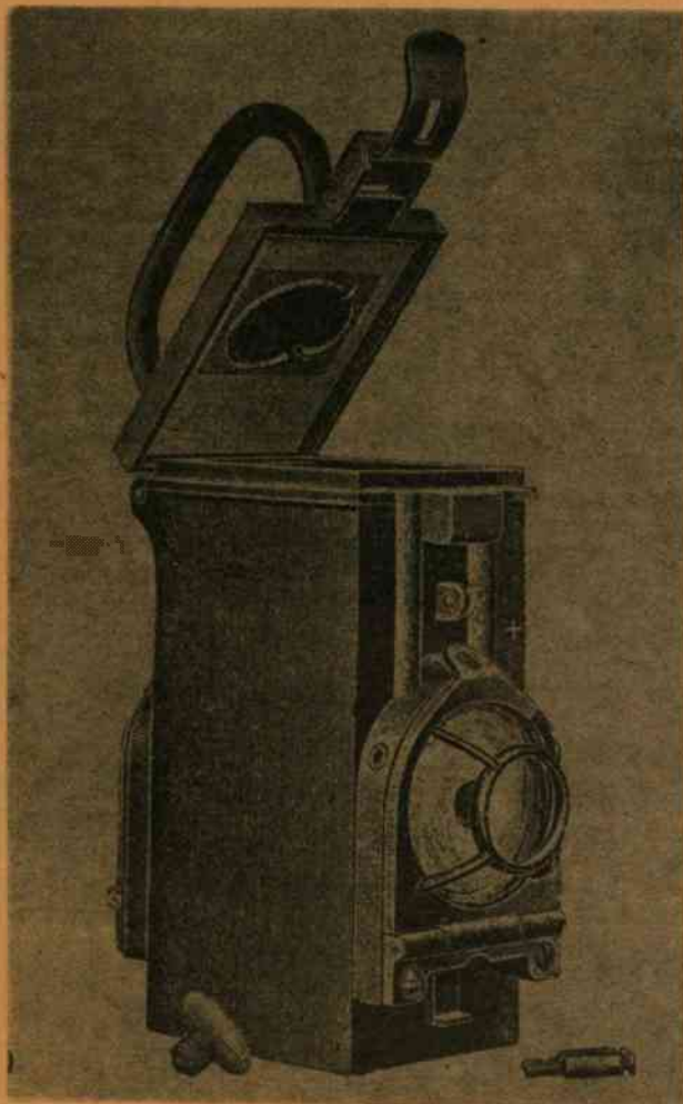
Elektryczna lampa bezpieczeństwa dla kopalni, model z roku 1906.
