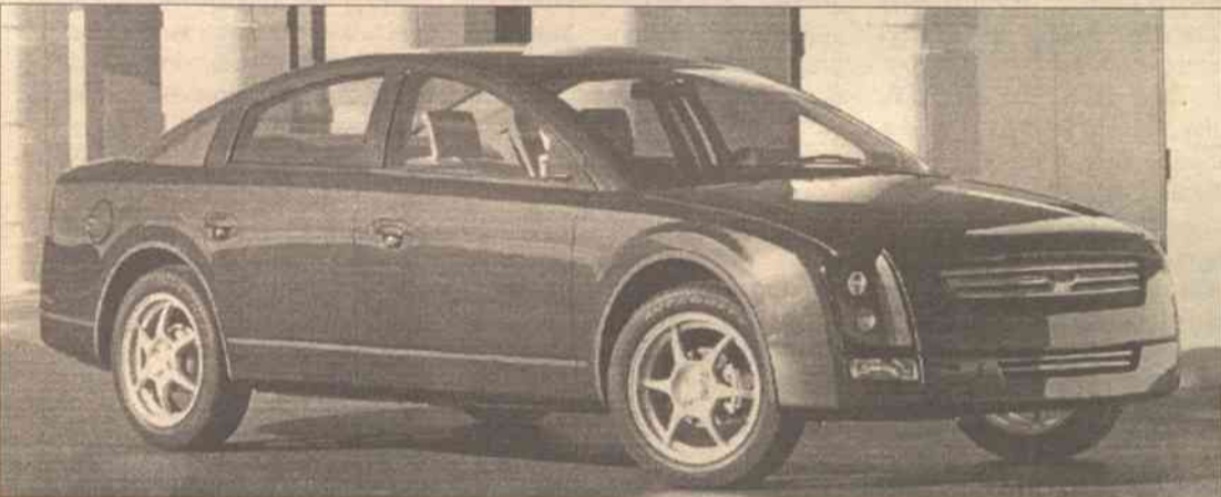
Ford Prodigy, który po raz pierwszy został zaprezentowany na salonie w Genewie, ma szansę stać się przebojem motoryzacji. Design nadwozia - jest takie, jakie jest - ale najważniejsze kryje się pod maską. Otóż jest to samochód z napędem hybrydowym, tzn. wyposażono go w tradycyjny silnik benzynowy (lub dieslowy) oraz elektryczny. Aluminiowy silnik DIATA o pojemności 1,2 l (121 KM!), jest o 35 proc. oszczędniejszy od innych benzynowych silników i zużywa mniej niż 3 litry paliwa na 100 kilometrów. Samochód posiada automatyczną skrzynię biegów ASM, która jest o 20 proc. oszczędniejsza od dotychczas używanych w świecie. Szkoda, ale w sprzedaży nowy ford pojawi się dopiero w roku 2003... Fot. producent
