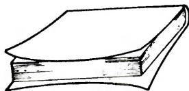
Rys. 33. Okładziny wypaczają się wskutek niewłaściwego przyklejenia wyklejek do tektury klejem zamiast klajstrem.
