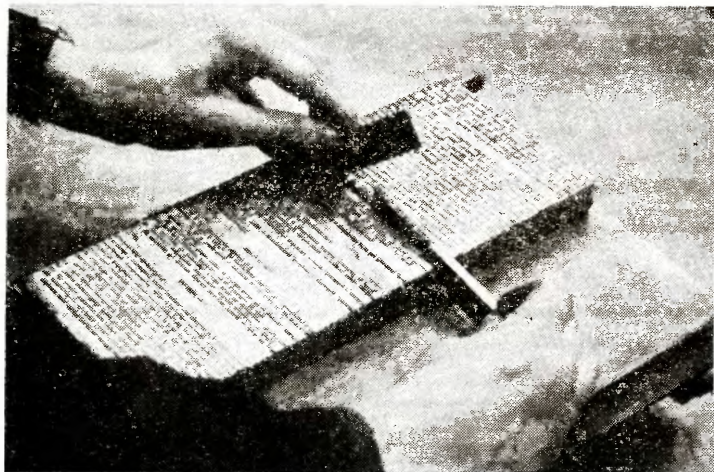
Rys. 16. Poprawianie korekty składu linotypowego. Lewą ręką składacz usuwa odlew zmyłonego wiersza, prawą wsuwa nowy.
