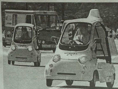
Nowy samochód elektryczny „MC-1T EV” został zaprezentowany przez Mitsubish podczas przeglądu w Tokio 8 kwietnia br. Silnik elektryczny zasilany wymiennymi bateriami (72V) może przejechać 50 km z maksymalną szybkością 60km/h. Cena tego pojazdu - 3900 USD. Fot. EPA-ELTA
