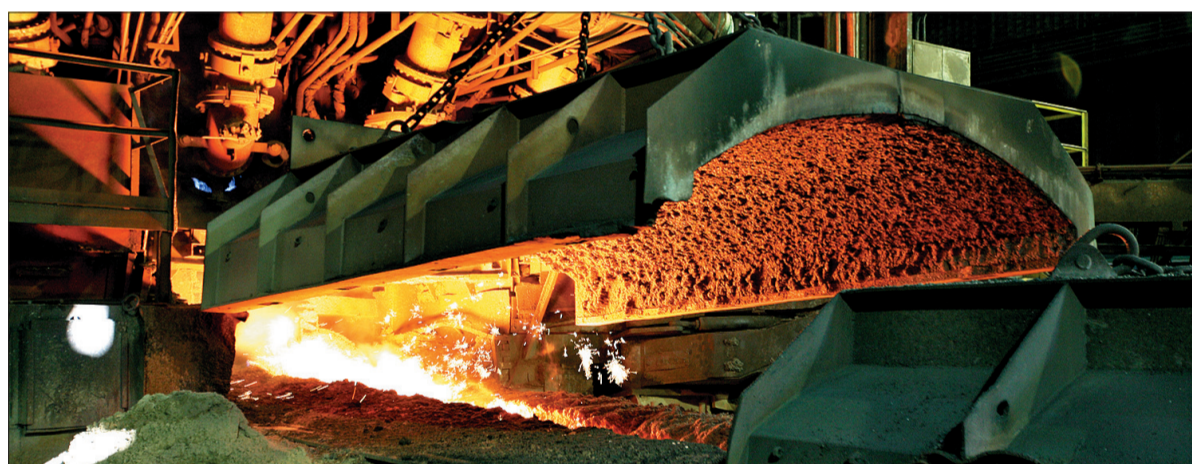
Spust surówki o temperaturze 1450 st. C z wielkiego pieca.
