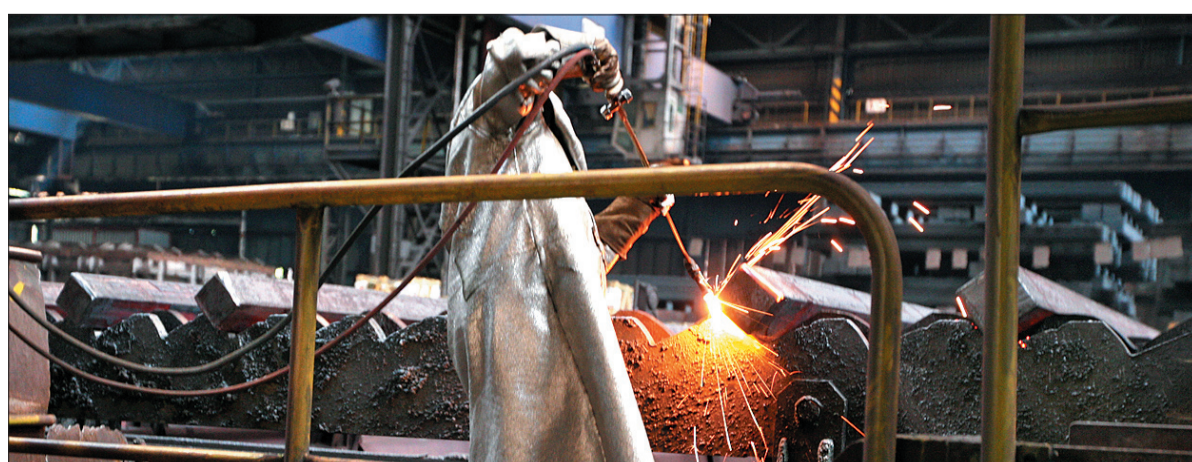
Niewielkie anomalie na kęsiskach usuwa się palnikiem gazowym.
